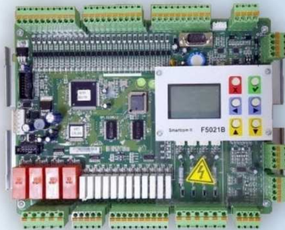
Bộ vi xử lý STEP F5021 (Loại thế hệ mới dùng cho thang tốc độ cao từ 80m/p trở lên)
